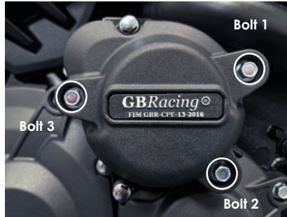
Bolt 3 SPB-9 M6X40HHF - 10Nm
