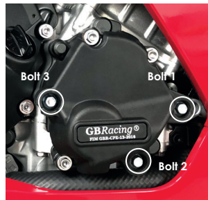
Bolt 3 M6X35HHF - 10Nm
