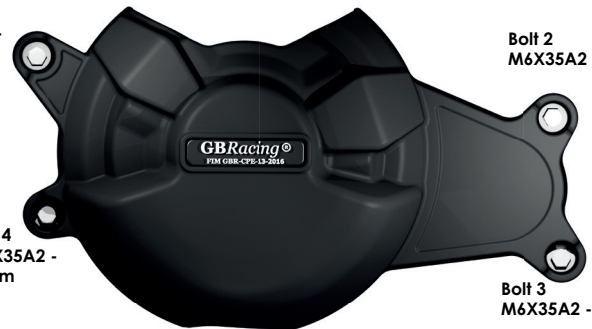
Bolt 1 M6X35A2 - 10Nm
